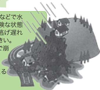
地盤の弱い緩やかな傾斜地で、大雨による地下水の増加などが原因で地盤がゆるくなり、ずり落ちるように崩れ落ちる。一度に広い範囲で起きるので被害が大きい。
