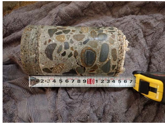
写真 2-2d 床コア抜き状況
