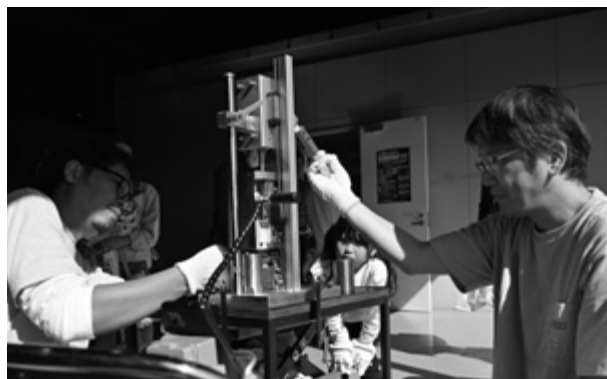
▲機械の型に流し込んだペットボトルキャップを熱で溶解中
