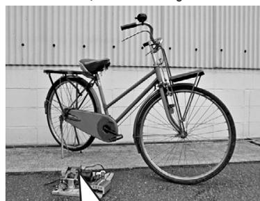
自転車をこぐと、車輪と接した矢印部分が回転し、発電する仕組み
