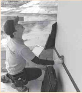
新築住宅の家屋評価の様子。壁の高さを、レーザー距離計を使用して測っているところです。
