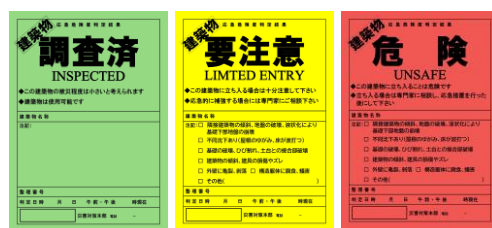
判定ステッカーの例 （建築物判定ステッカー）
