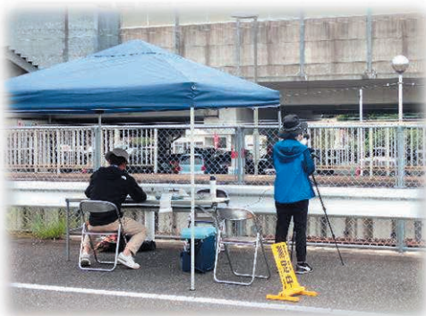
新幹線騒音振動測定
